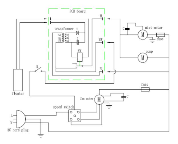
220~240 V/ 50 Hz «Wiring diagram»
